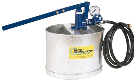
Handprüfpumpe mit Ø 30 mm Plunger, 28 cm<sup>3</sup> Fördervolumen je Hub, einschl. Ablassventil, Saugschlauch, Druckschlauch 3 m lang, Manometer 0-60 bar, verzinkter Behälter oval 30l und der Gebrauchsanleitung mit Ersatzteilliste.
